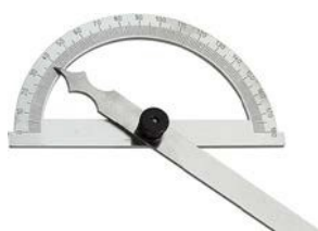
Winkelmesser – Genauigkeit liegt bei etwa 0,1 bis 0,5°
